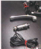
Bei Probefahrten wird mit Hilfe von Sensoren das zu prüfende Teil auf kritische Stellen und Materialbeanspruchung getestet. Dabei werden die gesammelten Daten ausgewertet und dienen als Grundlage für die eigentlichen Tests auf dem Prüfstand.
