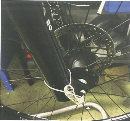
Kabelbinder als Zusatzsicherung.
