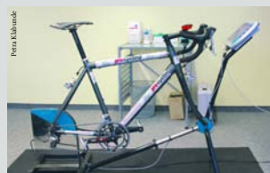
Lörcks' Präzisions-Ergometer aus der Leistungsdiagnostik bringt es an den Tag: Bei beiden Rahmen gleichen sich die Werte auf der Ergomo-Anzeige und der des Ergometers.
