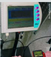
Lörcks' Präzisions-Ergometer aus der Leistungsdiagnostik bringt es an den Tag: Bei beiden Rahmen gleichen sich die Werte auf der Ergomo-Anzeige und der des Ergometers.
