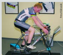
Lörcks' Präzisions-Ergometer aus der Leistungsdiagnostik bringt es an den Tag: Bei beiden Rahmen gleichen sich die Werte auf der Ergomo-Anzeige und der des Ergometers.
