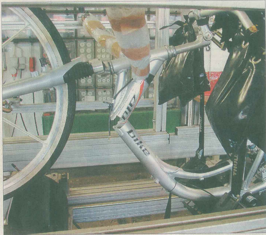
Gebrochen: Der Rahmen des Damenmodells vom Discounter auf dem Prüfstand.
