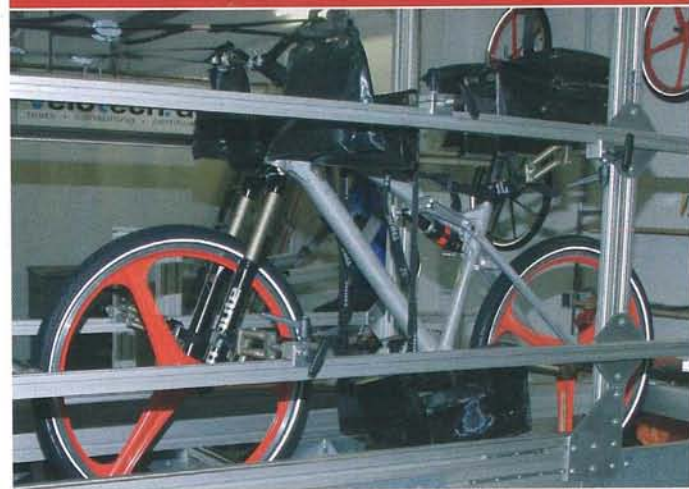
Der große Trommelbremsprüfstand: Auch Gabel und Laufrad werden wechselnden Rüttelbelastungen ausgesetzt.
