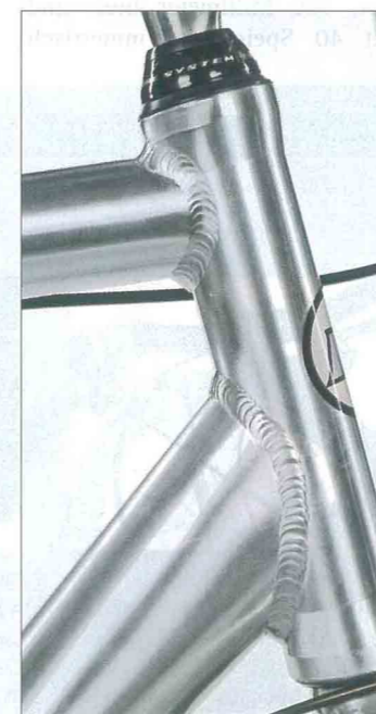
Kalkhoff: Armdicke Oversized-Rohre machen den Rahmen extra-stark. Maximal-Last: 185 Kilo!
