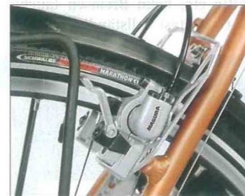
Diamant: Beim Hinterrad-Ausbau blockiert der Gepäckträger das Öffnen des Magura-Schnellspanners.
