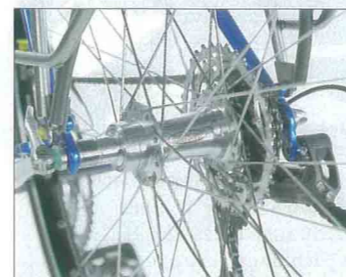
Santana: Eine Hadley-Tandemnabe mit 160mm-Einbaubreite und 40 Speichen am Hinterrad.
