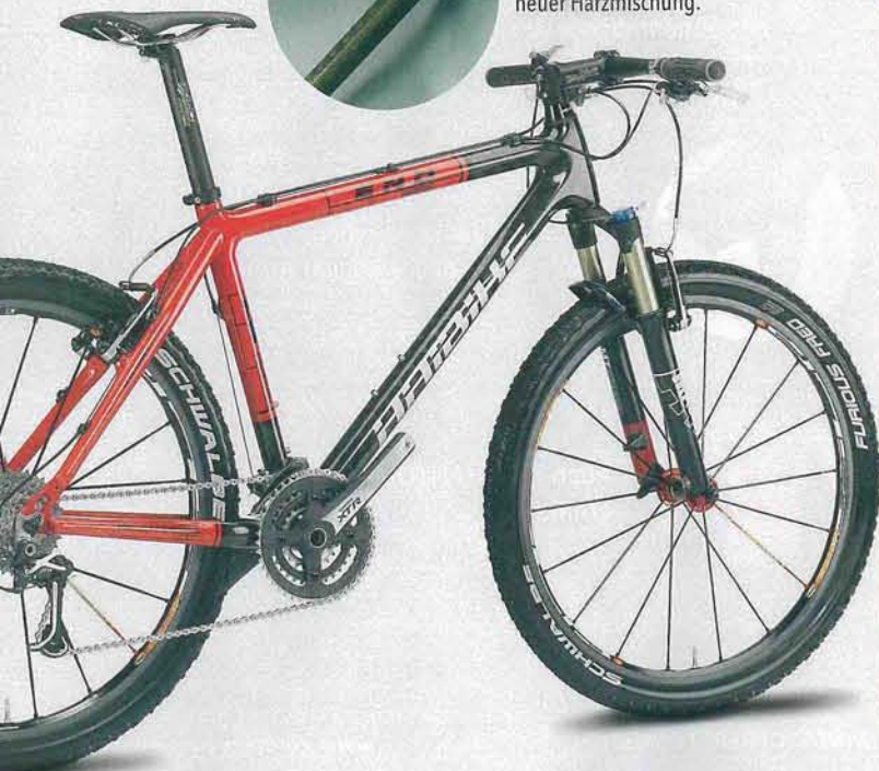
Stark gemacht: das Hai End 2008 mit zusätzlichen Kevlar-Lagen (links) und neuer Harzmischung.
