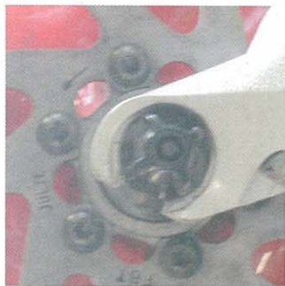
Vor und nach dem Test: Auf dem unteren Bild ist deutlich zu erkennen, dass der Schnellspanner im Ausfallende gewandert ist.
