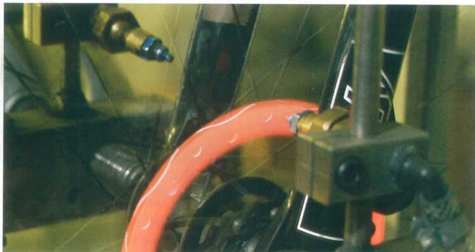
Velotechs Bremsenprüfstand. Zu sehen: eine ziemlich heiße Bremsscheibe. Lenker werden mit der „Big Bull 1“ – von Yusuf am Computer gesteuert – getestet.
