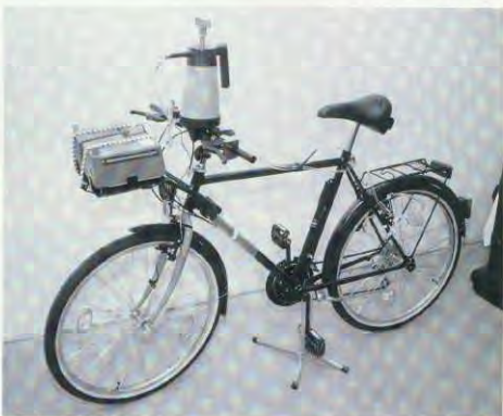
Bremsprüfung: Es geht auch ohne Rollenprüfstand, wie Ernst Brust mit diesem Fahrrad beweist. Der kastenförmige Motometer vor dem Lenker protokolliert die Verzögerung und wirft nach der Testfahrt ein Diagramm aus, das über Betrag und Verlauf der Bremskraft Aufschluß gibt. Der auf dem Lenker thronende Wasserbehälter versorgt die „Felgenspüler“.
