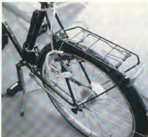
Die Düsen, aus denen das Wasser auf die Felgen strömt (0,3 bis 0,4 l/min bei 1,5 bar), müssen exakt ausgerichtet werden, um die Norm zu erfüllen.
