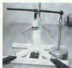
Statische Lenkerprüfung: einseitige Belastung mit 60 kg (entspricht einer Kraft von 600 N)
