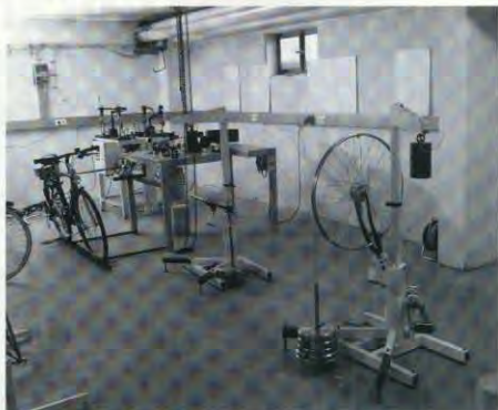
Teillansicht des Velo-Tech-Prüfzentrums: Ganz hinten in der Ecke erkennt man den Lenkerprüfstand, davor den Pedalprüfstand mit „angedocktem“ Fahrrad für den Gepäckträgerort. Die beiden Galgen (Mitte und vorn rechts) dienen der Prüfung von Lenker und Gabel.
