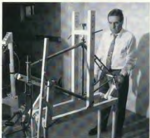
Diesen Prüfstand verlangt die DIN 79100 nicht. Ernst Brust hält das von Christian Smelik erdachte Gestell dennoch für wichtig, um die Steifigkeit von Gabel und Rahmen zu ermitteln und damit Aussagen über den Fahrkomfort zu erhalten.
