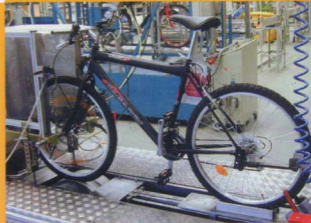
Das Mountainbike „Ragazzi Liner“ kommt zuerst auf den Bremsenprüfstand. Was für eine Überraschung: Die Scheibenbremse quietscht bei Nässe, besteht aber den Test.
